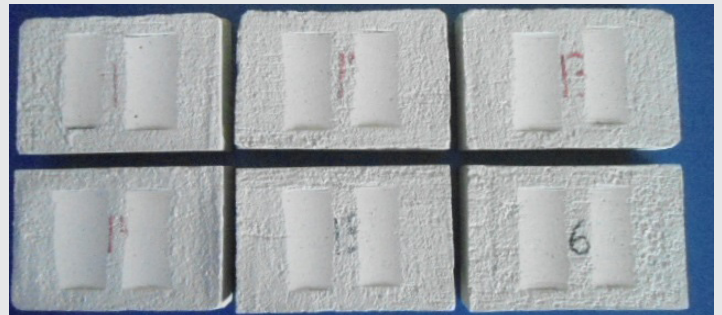
Figura 17. Probetas después del ensayo de abrasión.
