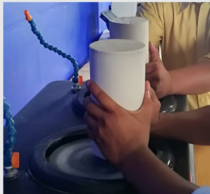
Figura 7. Lijado de las caras de las probetas: a) Probetas cilíndricas; b) Probetas prismáticas.
