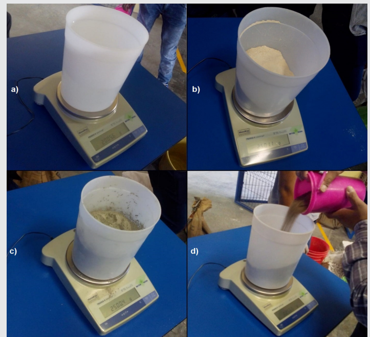
Figura 3. Fotografías del pesado de los componentes de la mezcla: a) Agua; b) Polvo de mármol; c) Cemento; d) Arena.
