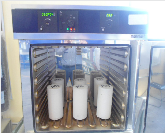
Figura 9. Secado de las probetas cilíndricas: a) Horno precalentado b) Probetas cilíndricas dentro del horno.
